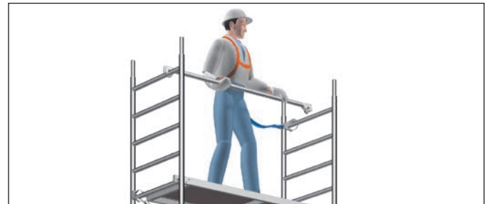
Bild 3: Sichere Montage der Rückenlehnen mit PSA
